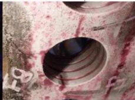
**DETECCION DE FISURAS A TRAVES DE PM Y LP**
