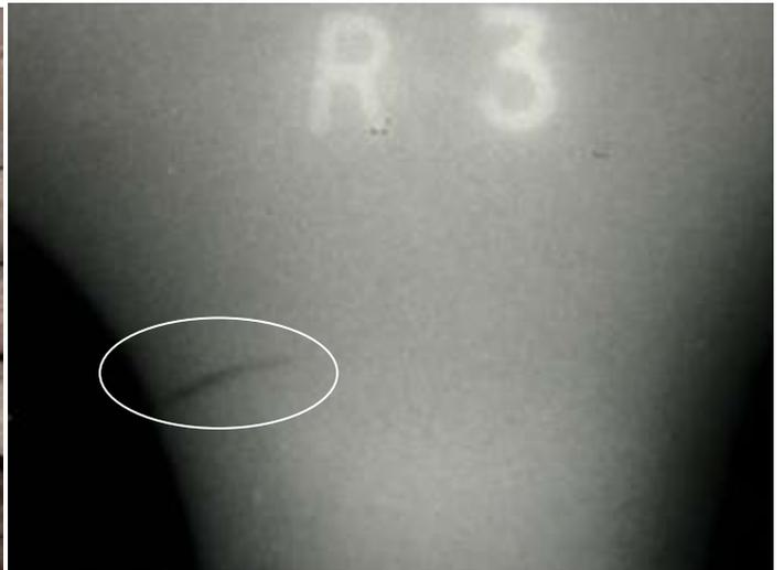
**Ensayo Radiográfico previo a la reparación**
