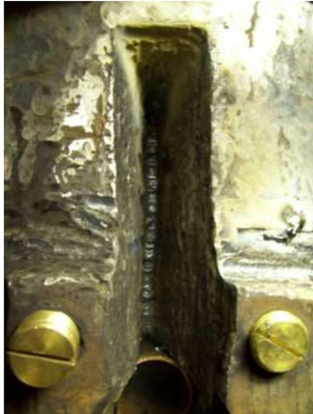
**Reparación de Fisura en Cilindro Prensa**
